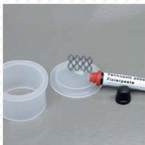
Fixeren met fixeerpasta. (Optioneel)
