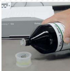
Inbedden met 2000 LC (optioneel toevoegen van Inside Cure) En plaatsen in Technotray.
