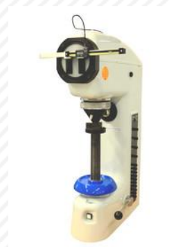
• Gemoderniseerde Vickers – Brinell meter met digitale uitlezing
