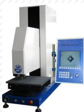
• Klein last hardheidsmeter HV0,025 tot HV30
