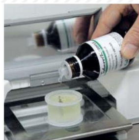
Aanbrengen van dunne een dunnen film afdeklak (laatste 2 minuten van het inbedproces)
